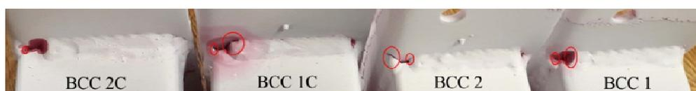
Figura 13 - Resultados ensaio de líquido penetrante.
