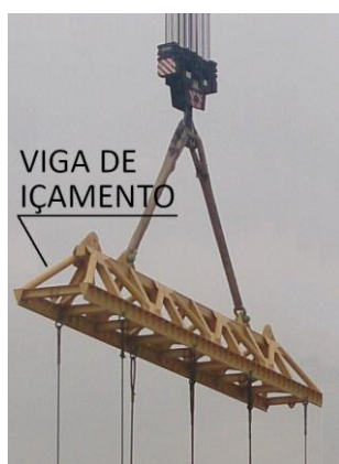
Fig. 4 – Viga de içamento
