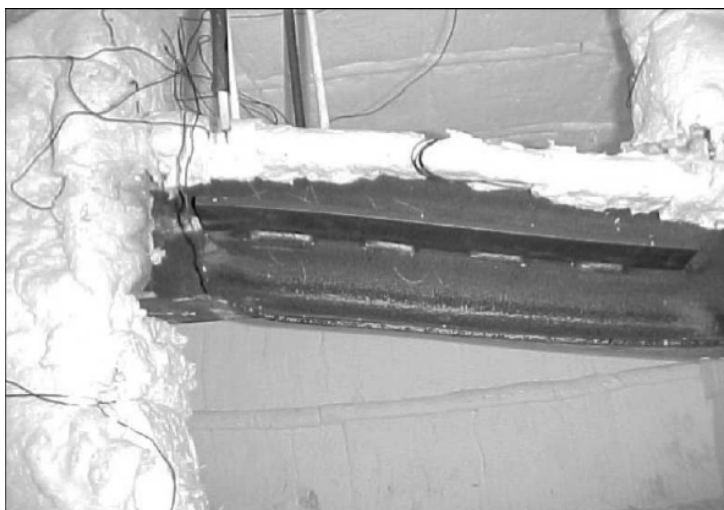
Figura 2.3 – Enrijecedor horizontal soldado na viga (Liu et al., 2002)
