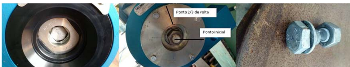
Figura 3 - Etapas do ensaio para o cenário 2: montagem do corpo de prova, início do ensaio, estado final do corpo de prova (ruptura frágil por torção).
