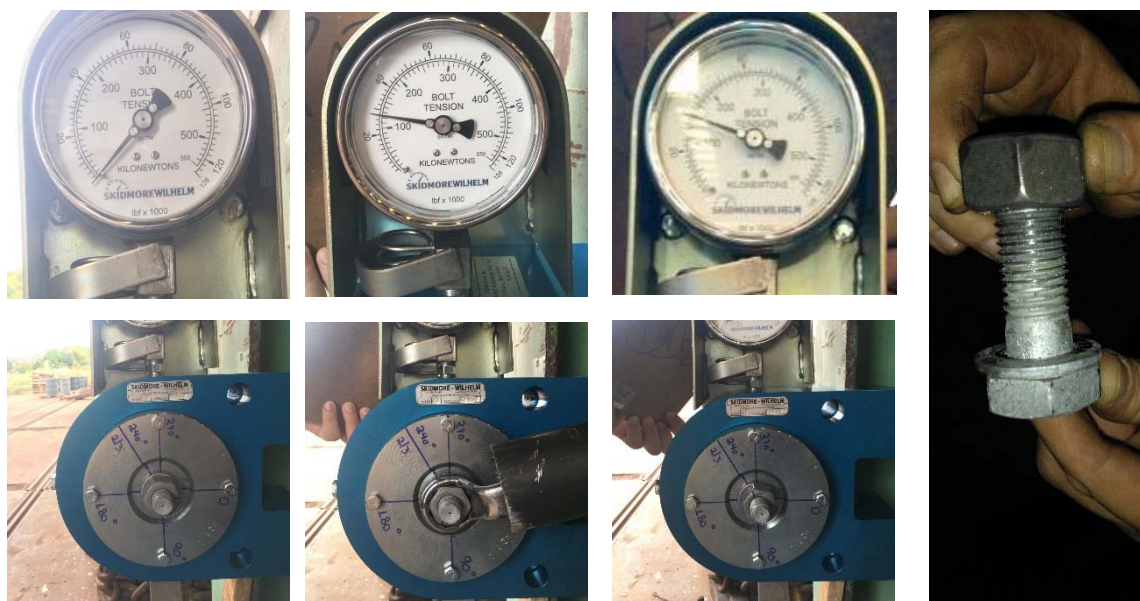
Figura 4 - Etapas do ensaio para o cenário 3: montagem do corpo de prova, corpo de prova atingindo 29 Kips em 1/3 de volta, final do ensaio com o corpo de prova atingindo 32 Kips em 2/3 de volta, estado final do corpo de prova (leve alongamento do corpo de prova).
