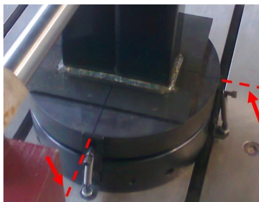
Figura 9 - Posicionamento dos corpos de prova e chapa de extremidade
