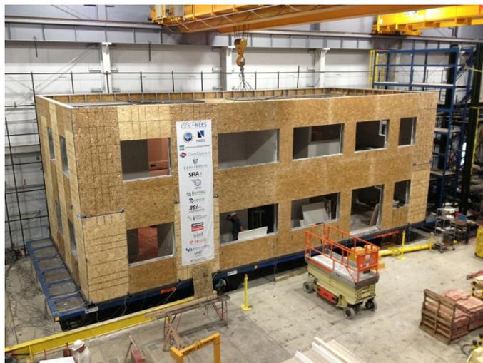
Figura 8 – Ensaio dinâmico de sistemas estruturais steel-frame recentemente disponibilizado em: <[www.ce.jhu.edu/schafer](http://www.ce.jhu.edu/schafer)>. Acesso em: out. 2013.
