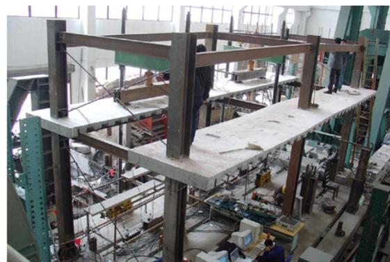
Figura 7 – Experimento de pórtico espacial com enfoque nas ligações semirrígidas, fonte: Wang and Li (2007).
