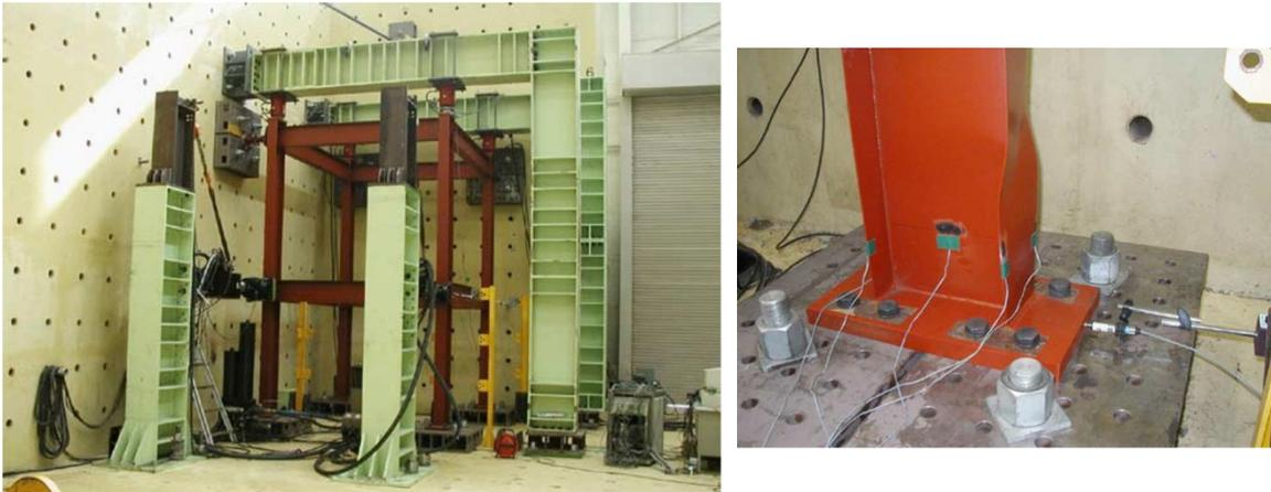
Figura 5 – Experimentos de pórticos tridimensionais (seções não compactas), fonte: Kim and Kang (2004).
