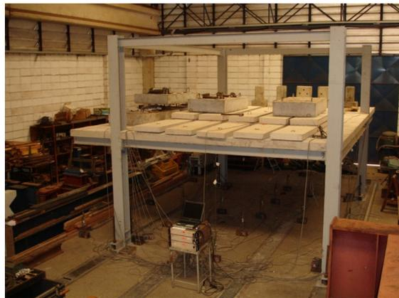
Figura 6 – Experimento de pórtico espacial com laje mista, fonte: Higaki (2009).
