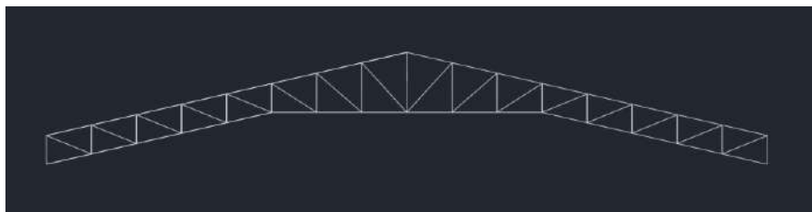
FIGURA XX – Geometria que favorece esforços de compressão nos montantes e diagonais
