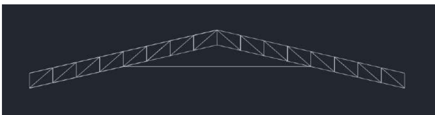
Figura 15- Tirante para estrutura com banzos integralmente paralelos
