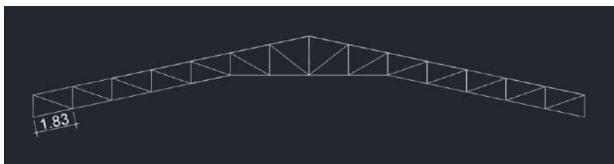
Figura 12- Distância entre terças para 14 divisões
