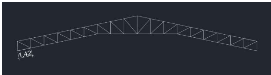
Figura 13- Distância entre terças para 18 divisões
