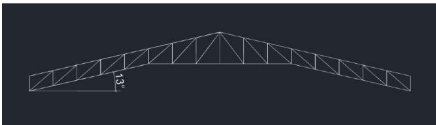
Figura 9 - Inclinação da treliça
