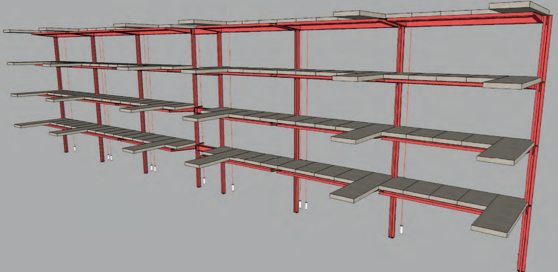
DETALHES DA ESTRUTURA DA PASSARELA DE CIRCULAÇÃO COM TIRANTES
